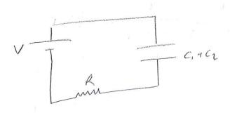
$$T(t) = (c, +c_1) \vee \frac{1}{R(c, +c_2)} e^{-t/R(c_1+c_2)}$$
